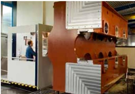
häufig in einer Aufspannung, sodass Ungenauigkeiten beim Rundlauf, Planlauf oder an den Symmetrie-Achsen des Werkstücks keine Chance haben. Das ist ein wichtiges Plus für Genauigkeit und Zeitgewinn. „Wir mischen Fräsen und Drehen so, wie es für den Fertigungsablauf am besten ist. Dann passt das Teil nach der Fertigung“, sagt Dettenweitz.
