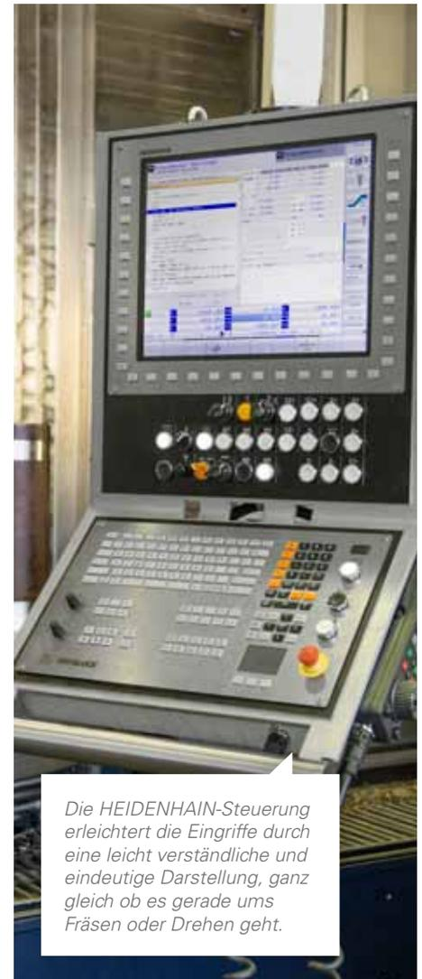
*Die HEIDENHAIN-Steuerung erleichtert die Eingriffe durch eine leicht verständliche und eindeutige Darstellung, ganz gleich ob es gerade ums Fräsen oder Drehen geht.*
