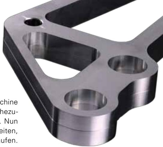
Deutlich sichtbar durch die Doppelbearbeitung: Die aus der Erwärmung des Kugelgewindetriebs resultierende Abweichung von 70  $\mu$ m
