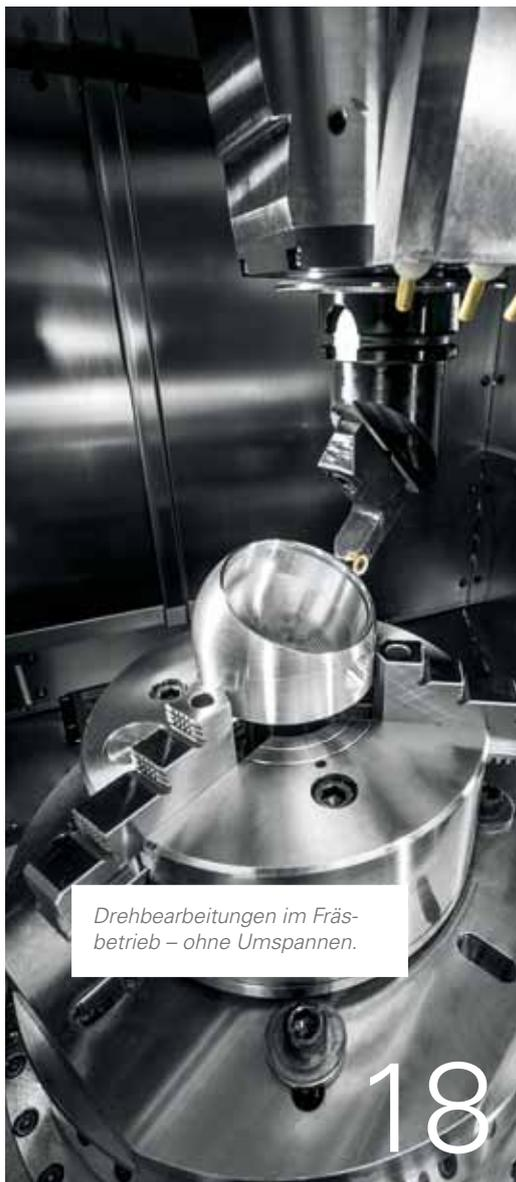
Drehbearbeitungen im Fräs-betrieb – ohne Umspannen.
