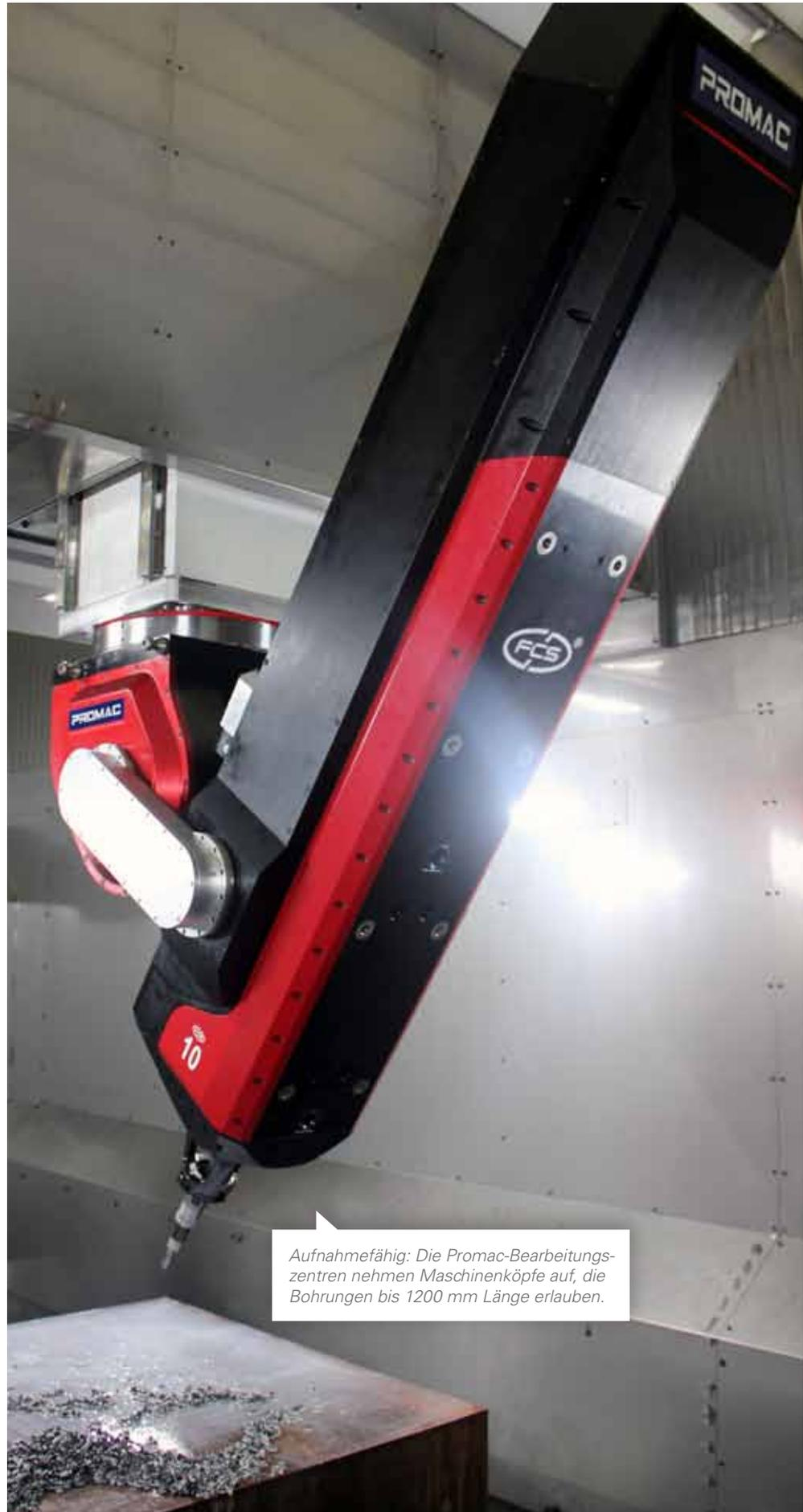
*Aufnahmefähig: Die Promac-Bearbeitungszentren nehmen Maschinenköpfe auf, die Bohrungen bis 1200 mm Länge erlauben.*
