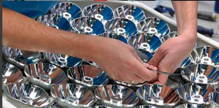
*L'alignement précis des logements des blocs LED est important pour obtenir un champ lumineux homogène*
