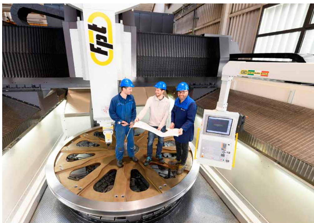
Christof Karlegger (a sinistra), Ing. Peter Plattner (al centro) e Franz Frei (a destra) durante l'attrezzaggio della possente puleggia per l'aeroporto di Londra Luton: è evidente quanto spazio ancora ci sia per particolari di maggiori dimensioni.
